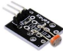
È un resistore variabile che diminuisce la sua resistenza quando la luce lo attraversa. È un dispositivo di input analogico, il che significa che leggiamo non solo due stati (0 e 1) ma molti valori compresi tra 0V e 3.3V o in caso di valori IDE Arduino tra 0 e 1023 rispettivamente.
