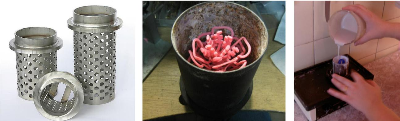
[Cilindri per fusione a cera persa, inserimento del modello, colata dell'impasto di gesso](#)
