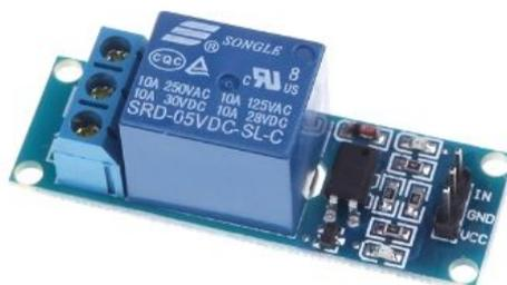
Un relè è un interruttore azionato elettricamente. Molti relè utilizzano un elettromagnete per azionare meccanicamente l'interruttore e fornire isolamento elettrico tra due circuiti. In questo progetto useremo un NodeMCU per controllare il relè. Svilupperemo un semplice circuito per dimostrare e distinguere tra i terminali NO (Normalmente aperto) e NC (Normalmente chiuso) del relè.
